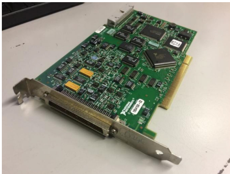
Рис. 7. Фото используемой платы ввода-вывода PCI 6024E
