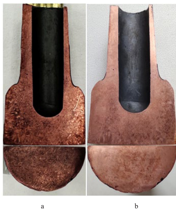
Рис. 9. Макроструктура литых – штампованных электродов: (а) литье – штамповка – закалка; (б) литье – штамповка – закалка – старение
