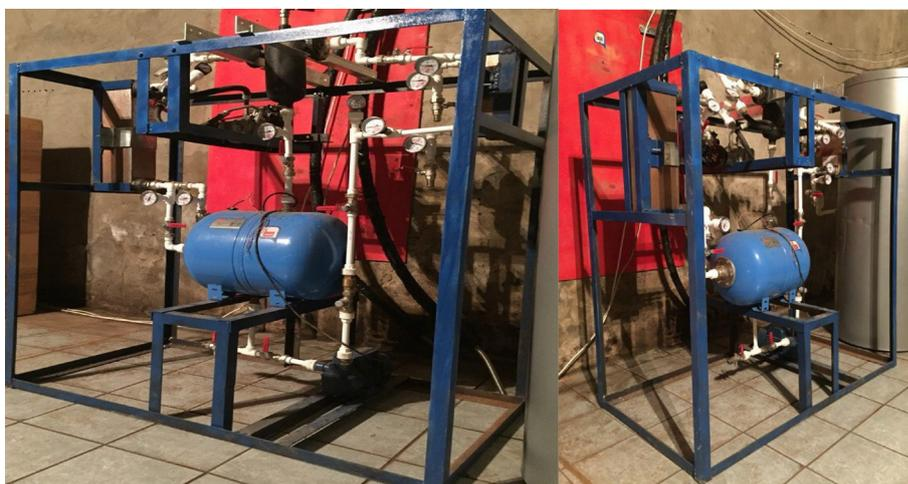
Рис. 5. Экспериментальная установка ОЦР на 4 кВт
