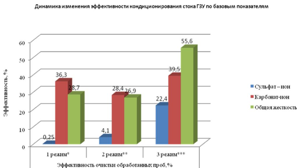
Рис. 2. Динамика изменения эффективности кондиционирования стока ГЗУ при различных режимах кавитационной обработки
