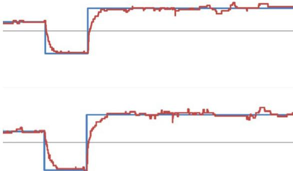
Рис. 14. Графики переходных процессов обоих регуляторов при изменении одной уставки
