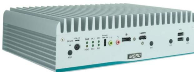
Рис. 7. Промышленный безвентиляторный ПК
