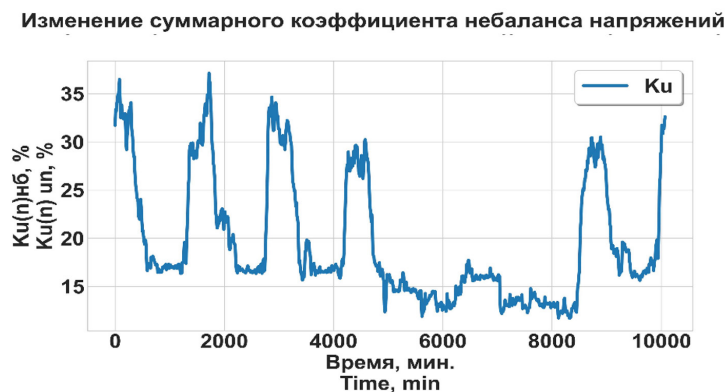
Рис. 9. Изменение суммарного коэффициента небаланса напряжения в исследуемой электрической сети Университета
