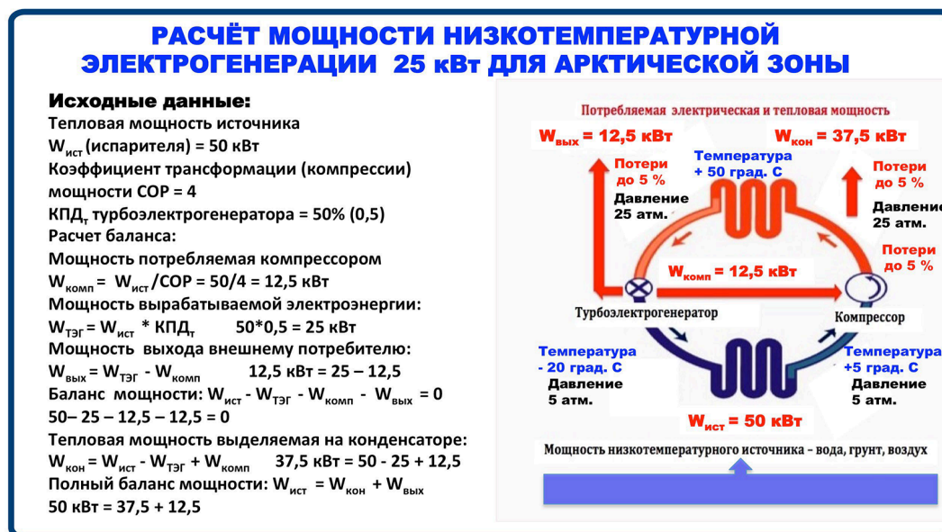
Рис. 1. Баланс мощности низкотемпературного электрогенератора
