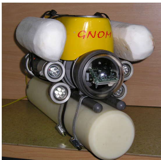
Рис. 1. ТНПА «ГНОМ» с установленным прототипом спектрометра РЭМ-26
