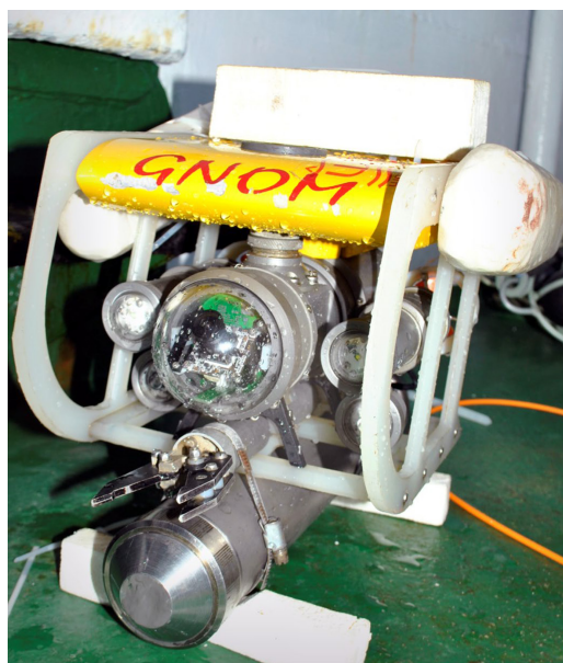
Рис. 2. ТНПА «ГНОМ» со спектрометром РЭМ-26
