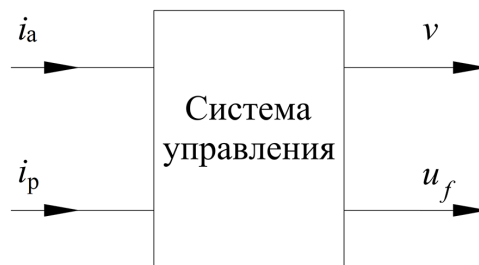
Рис. 1. Модель «чёрного ящика» системы управления мощностью
