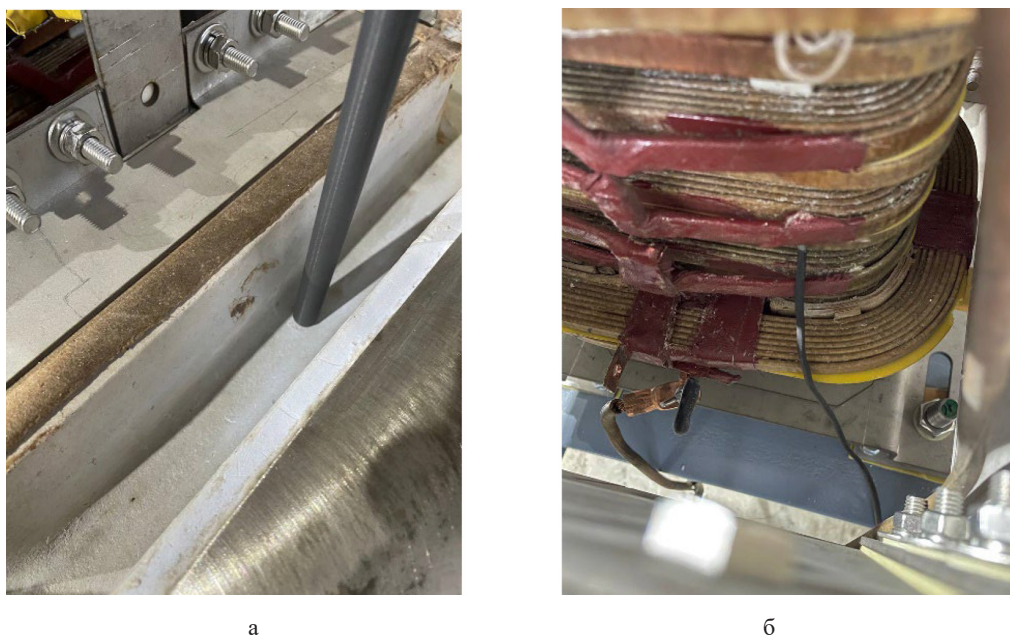
Рис. 2. Размещение термопары в огнеупорном желобе (а) и на обмотке индуктора (б)
