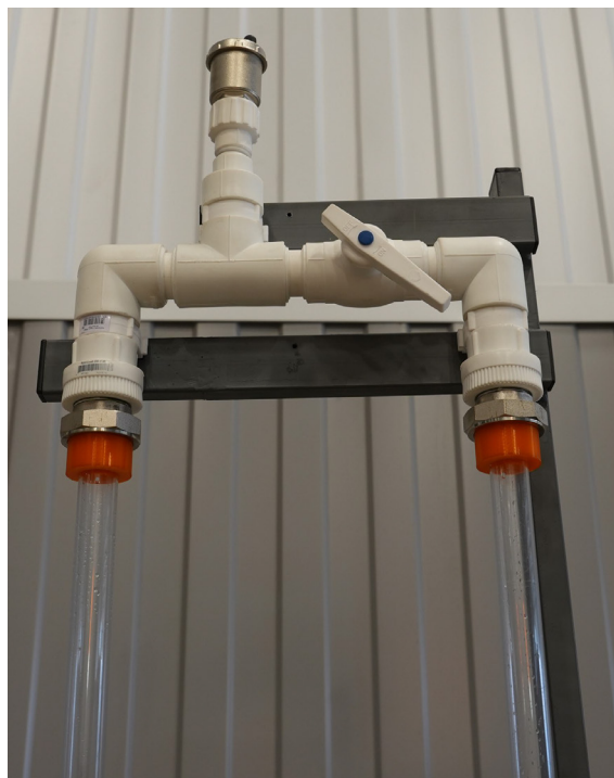
Рис. 4. Узел, имитирующий гидравлическое сопротивление потребителя
